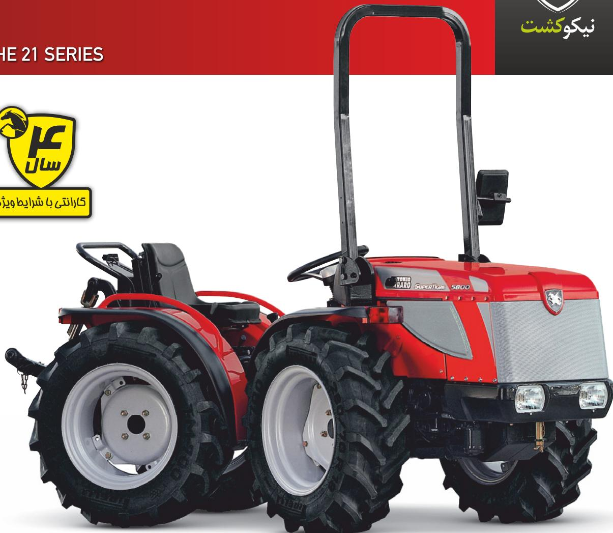
تراکتور کمرشکن باغی **SUPERTIGRE 5800** یک محصول جدید از تراکتورهای بی نظیر سری ۲۱ شرکت **CARRARO** با دو دیفرانسیل و چرخهای هم اندازه برای کار در زمین های هموار و همچنین ناهموار تپه‌ای و کوهستانی طراحی و ساخته شده است. تناسب بین وزن و توان تراکتور، توزیع بار بهینه بین چهار چرخ، حداکثر تعادل و پایداری دستگاه همراه با حداکثر زاویه چرخش فرمان جهت دور زدن در کمترین مساحت و همچنین توانایی دستگاه برای مانورهای سریع و مناسب از ویژگی های بارز و منحصر به فرد این محصول می‌باشد.
